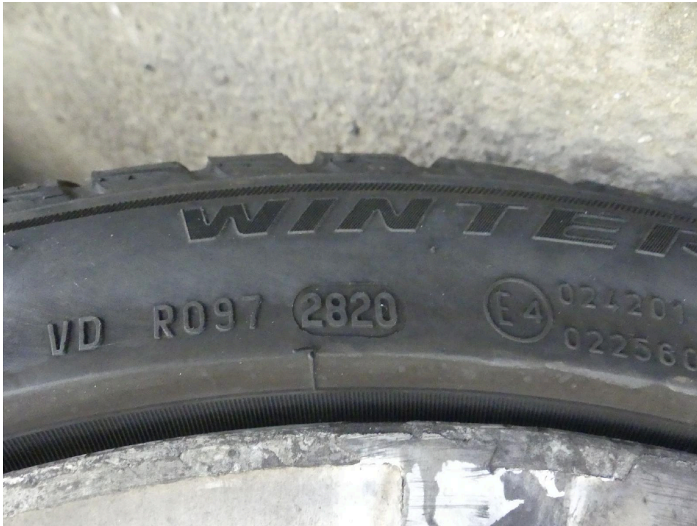
Bild: 17 Ausweisung der DOT Nummer der Radialreifen
