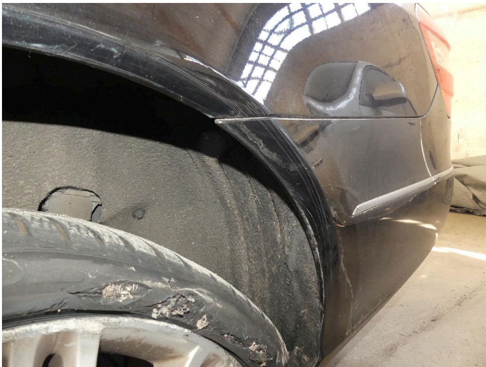
Bild: 52 Detailansicht Heckverkleidung und Seitenwand links, diese sind sichtbar im Lackaufbau markiert / beschädigt.
