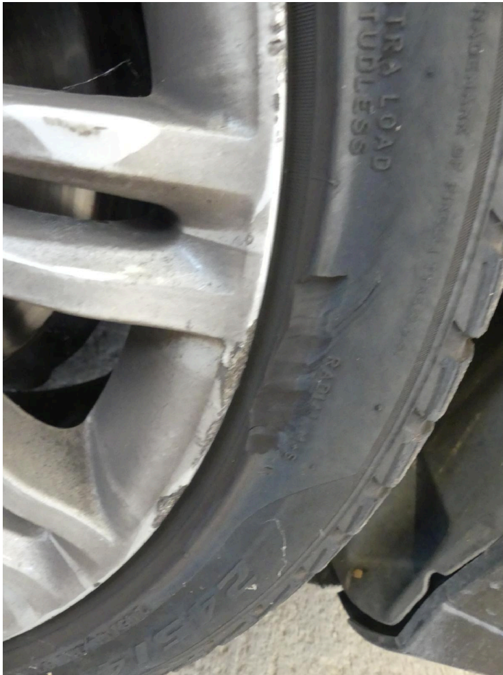
Bild: 18 Detailansicht Radialreifen, Materialausbruch vorhanden.
