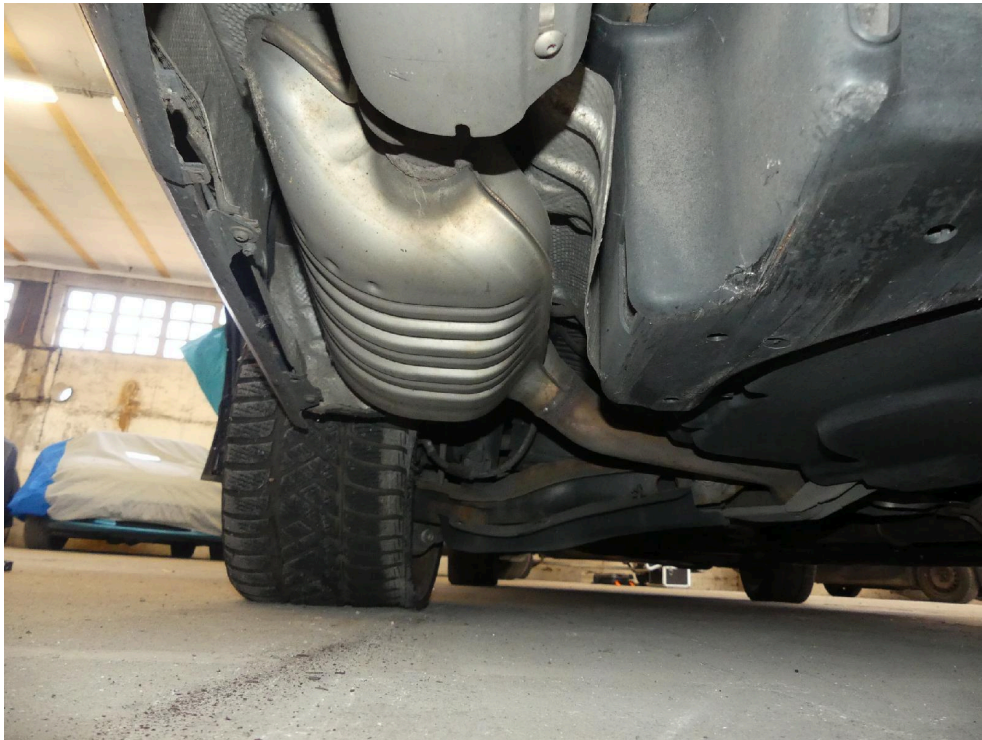
Bild: 55 Detailansicht Abgasanlage links
