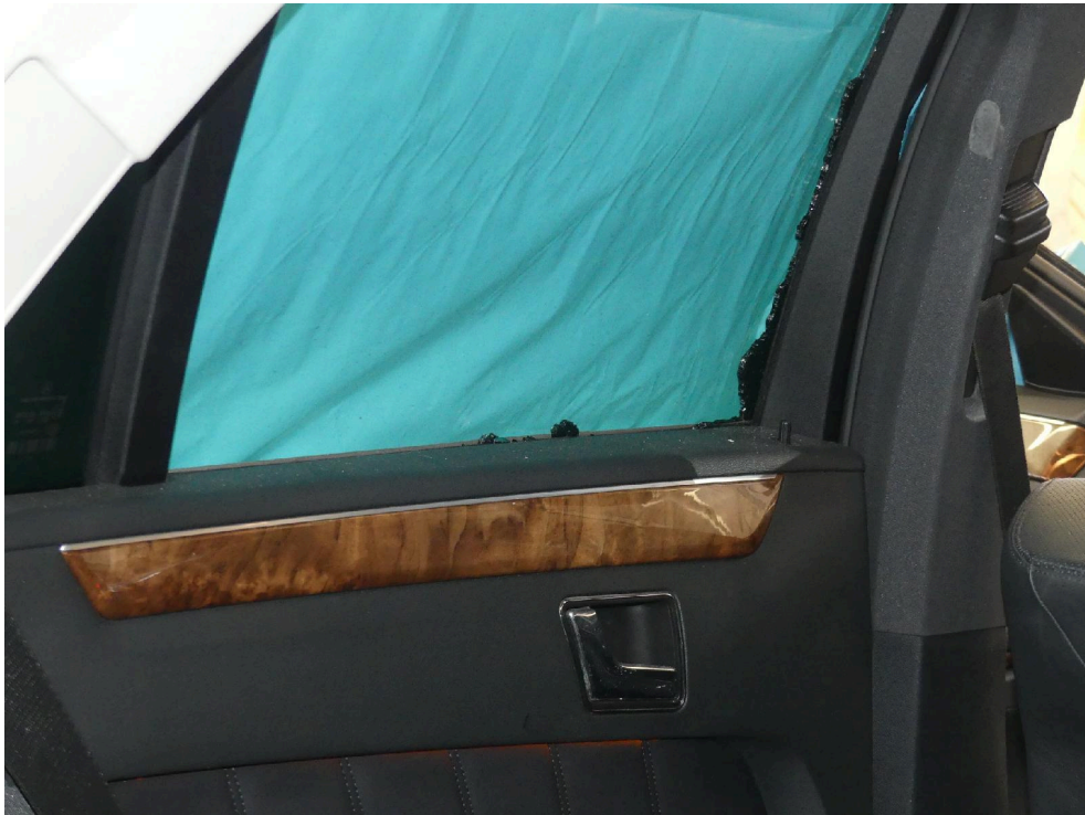
Bild: 31 Detailansicht Fondtür links, die Türscheibe ist zerstört.
