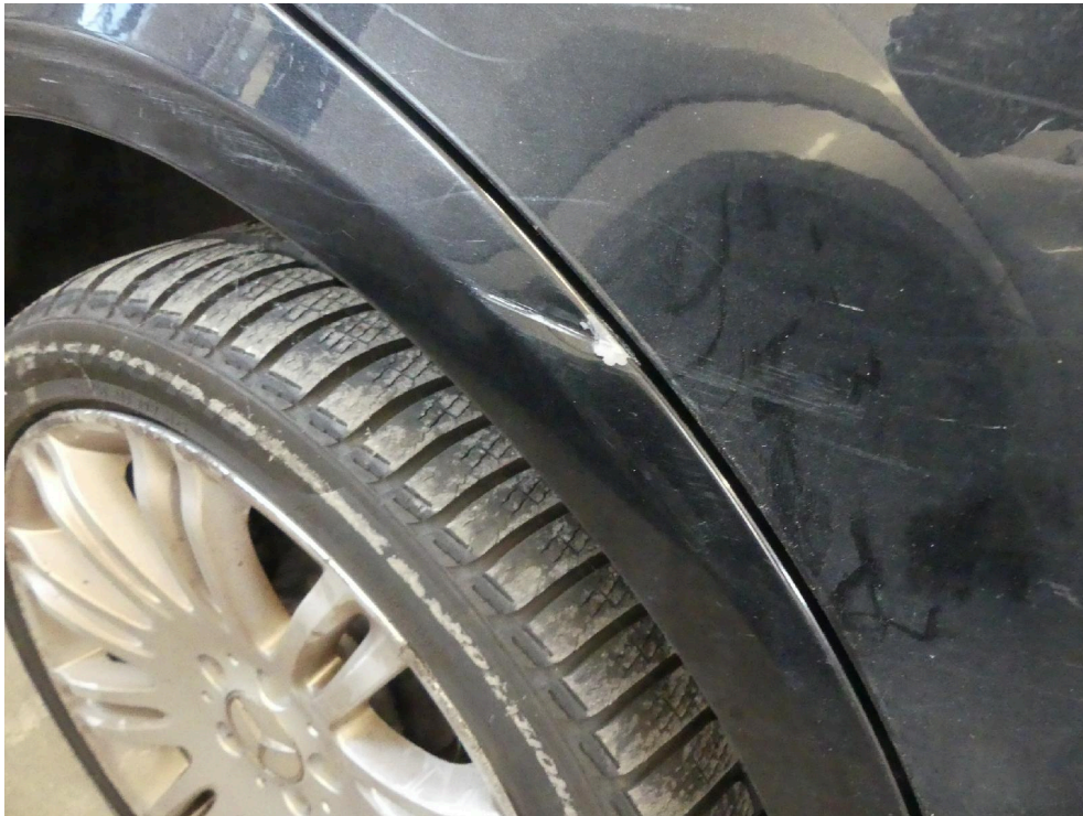
Bild: 57 Radlaufbogen Seitenwand rechts deformiert.
