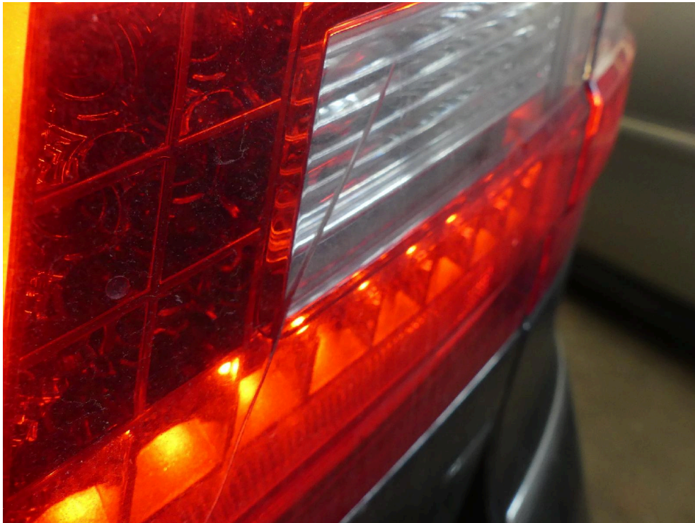
Bild: 53 Rückleuchte in Heckklappe rechts gerissen.
