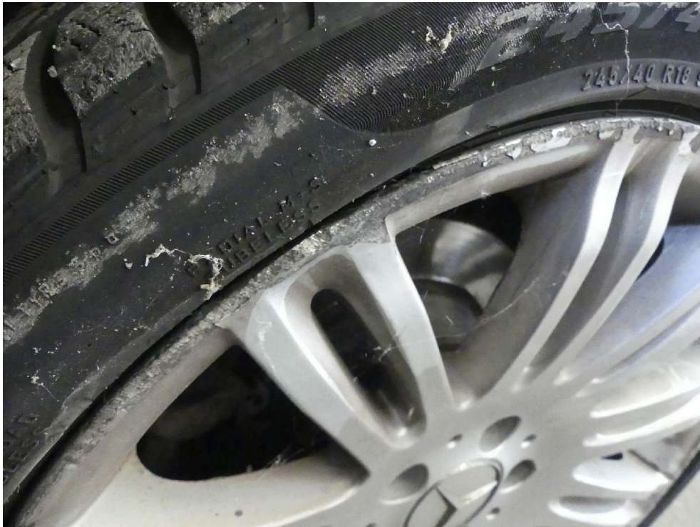
Bild: 13 LM-Felge im Grundmaterial abgetragen.
