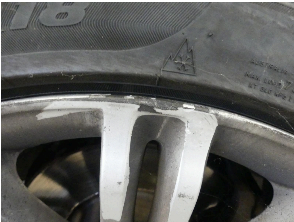
Bild: 16 LM-Felge sichtbar beschädigt.
