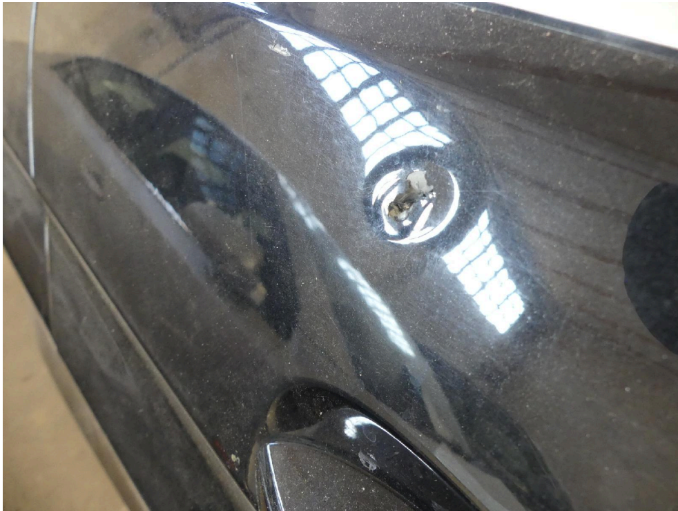
Bild: 61 Türaußenhaut der Fondtür rechts durchstoßen.
