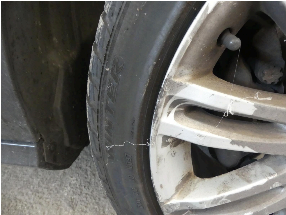
Bild: 19 LM-Felge vorn rechts beschädigt.
