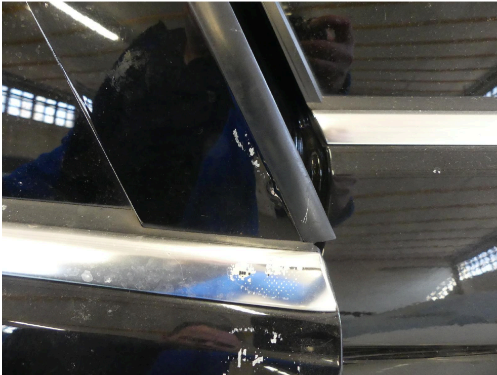
Bild: 51 Zierblende Fondtür links beschädigt.
