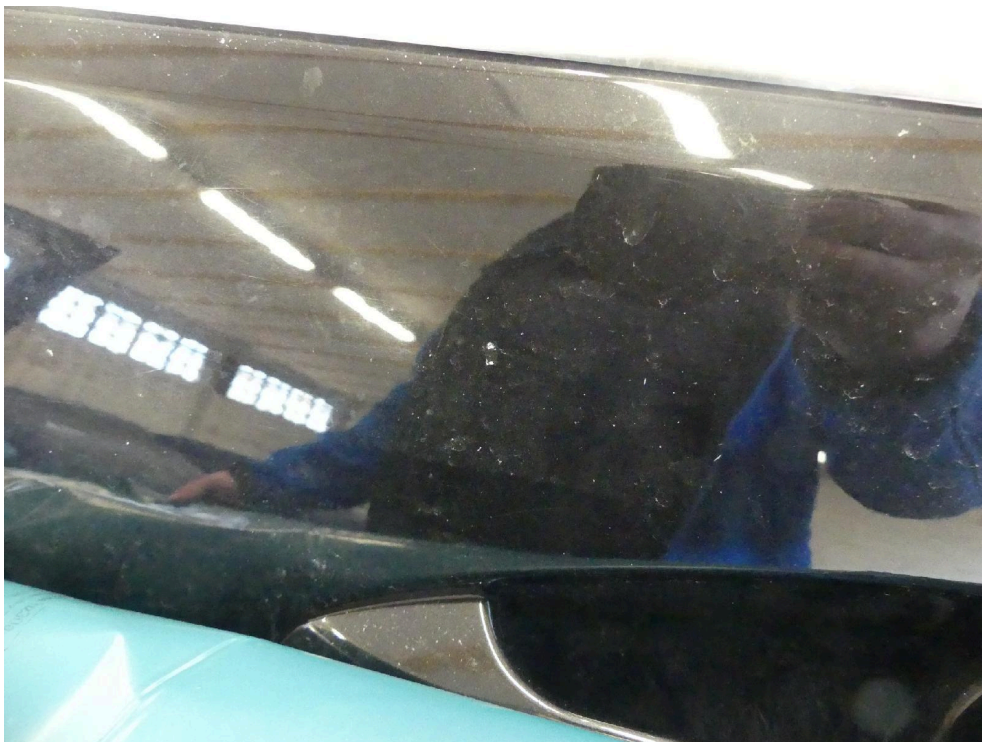
Bild: 50 Fondtür links Lackaufbau signifikant durch Glasbruch beschädigt.
