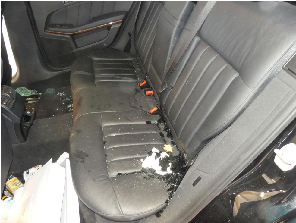
Bild: 33 Ansicht Innenraum Fondbereich, Rückstände Scheibenbruch sind vorhanden.
