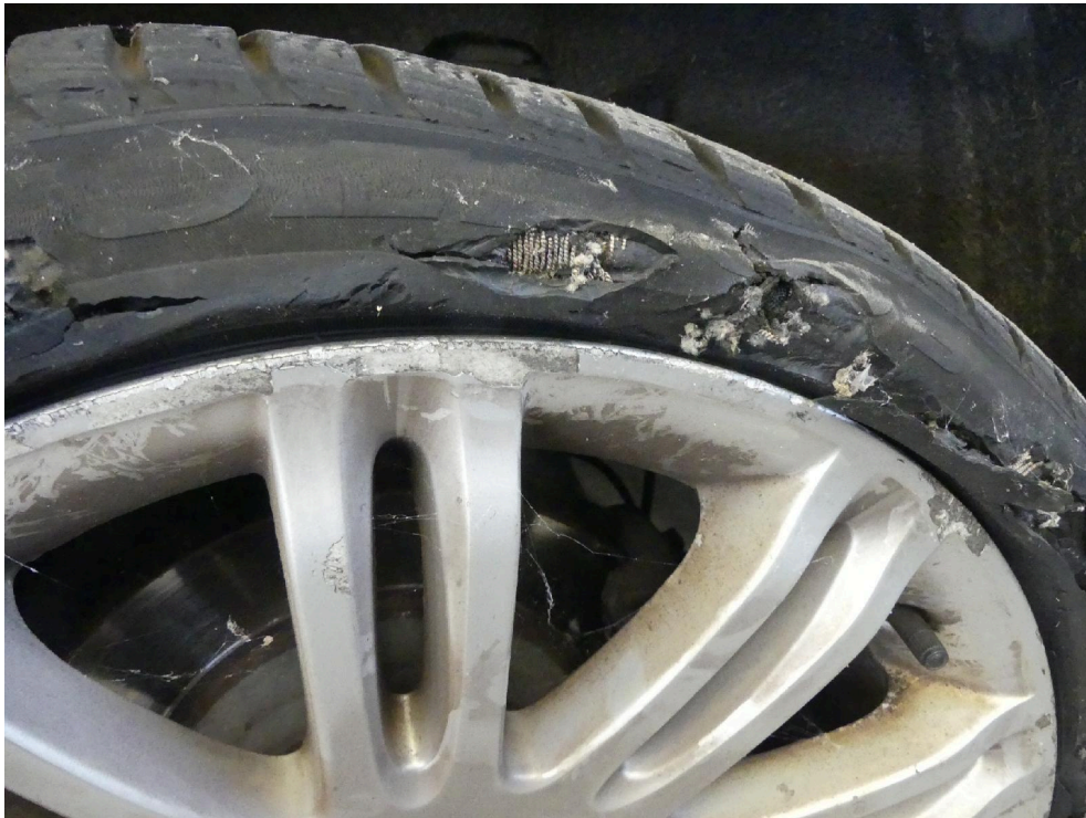
Bild: 11 Reifen zerstört - LM-Felge beschädigt.
