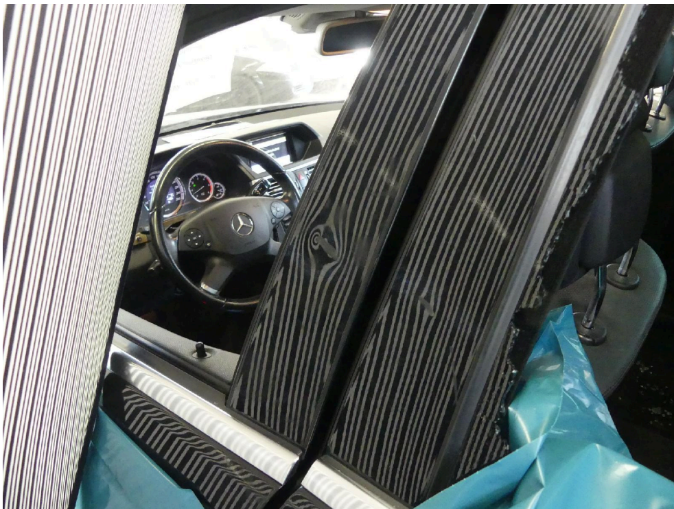
Bild: 48 Detaillierte Darstellung zur visuellen Verdeutlichung des Materialeinzuges mittels Liniensegels.
